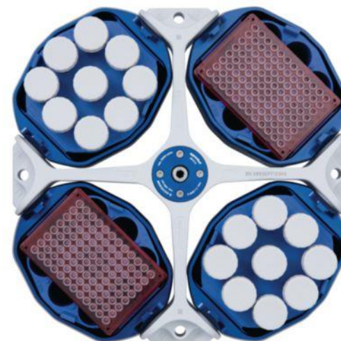
Универсальные адаптеры - один адаптер для планшетов и пробирок
