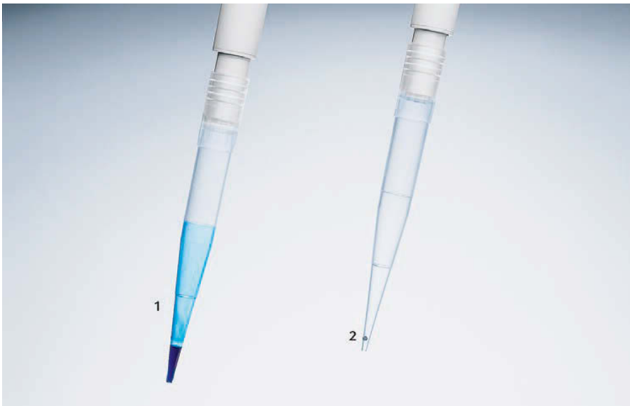
“Pearl Effect” — сравнение объемов остаточной жидкости при пипетировании растворов, содержащих детергенты:
