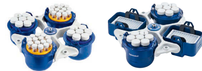
Центрифуга Centrifuge 5810/5810 R Возможность смешанной загрузки: Роторы S-4-104 и A-4-81 предоставляют возможность смешанной загрузки благодаря 2 бакетам для планшетов и 2 круглым/прямоугольным бакетам.
