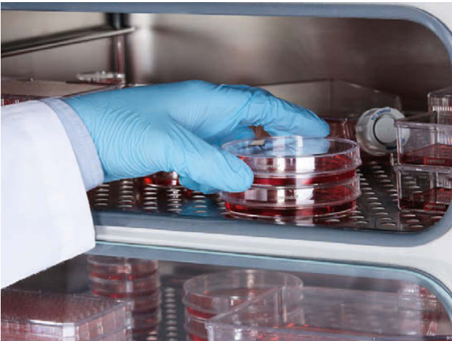
Опциональные раздельные внутренние дверцы облегчают доступ к пробам без необходимости полного раскрытия камеры
