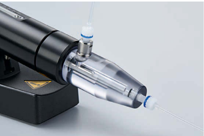
Новая система заливки масла помогает избежать разбрызгивания масла и облегчает процесс заполнения
